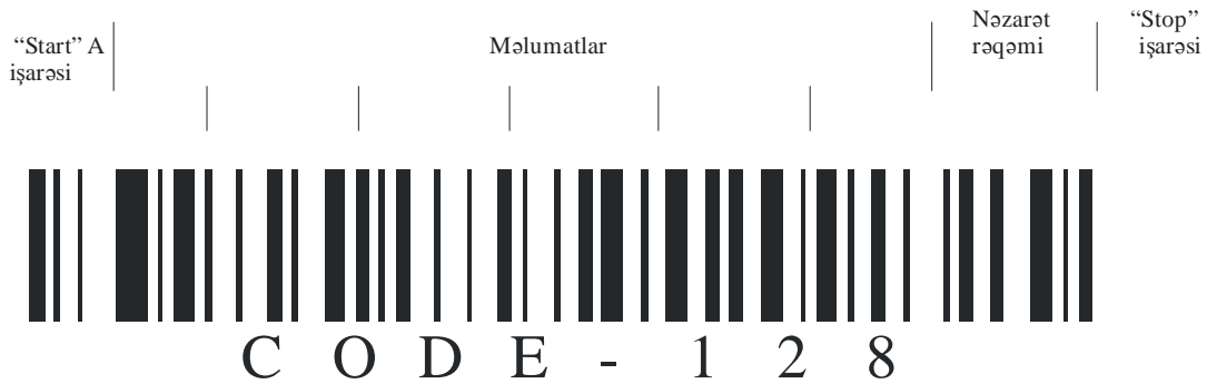
Şəkil 3- Kod 128-in kodlaşma sətrinin strukturunu
